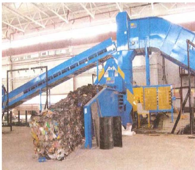
La prensa se suministra con su correspondiente tolva de alimentación, para su acoplamiento a la cinta alimentadora, construida toda ella con chapa de acero antidesgaste de dureza 320 Brinell y de 4 mm de espesor y reforzada con perfiles laminados.
